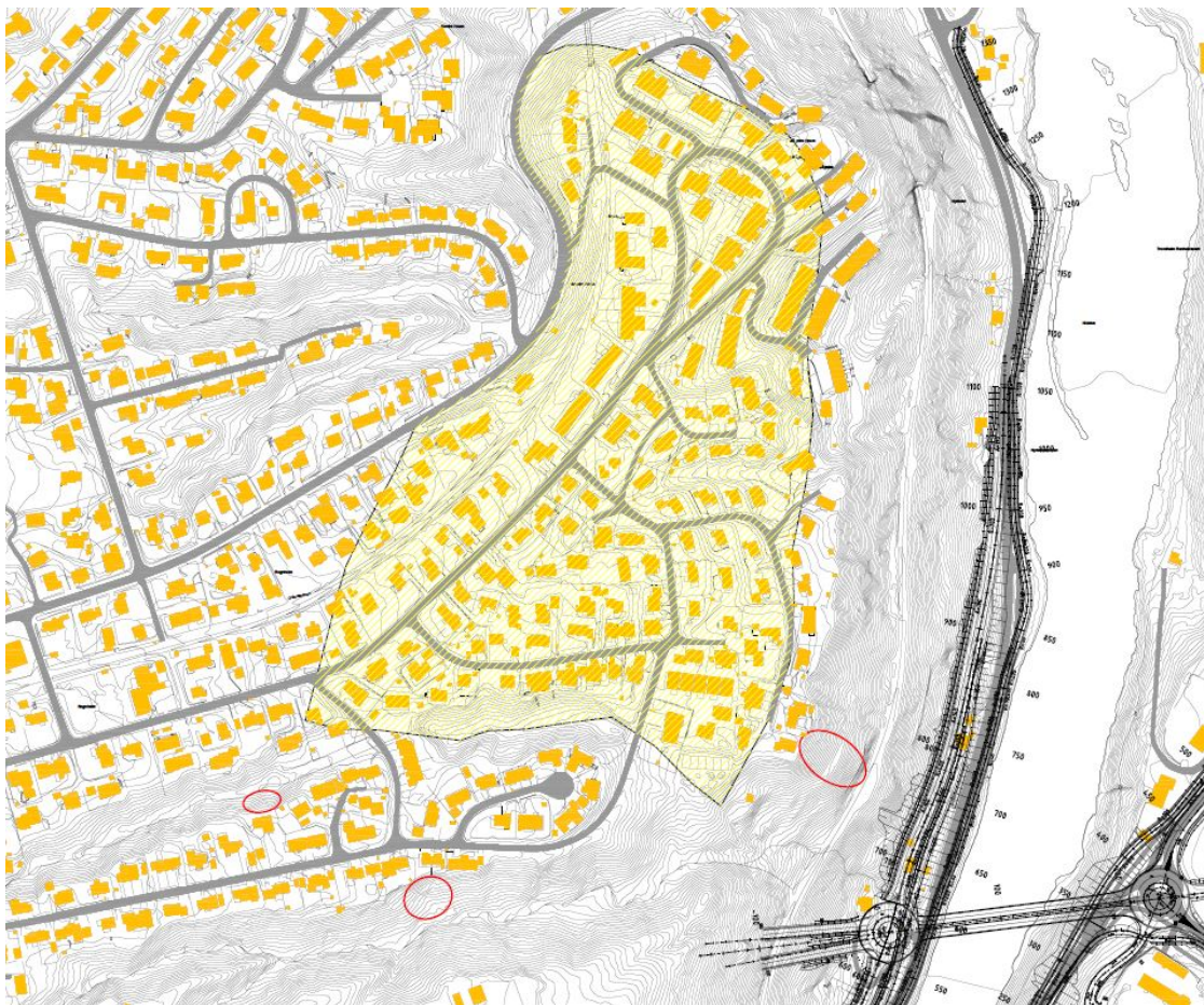
Figur 2-1 Beliggenhet av eksisterende kvikkleiresone nr. 202 Hoem samt planlagt veganlegg. Tidligere skredhendelser i tilknytning til området er markert med røde sirkler.
