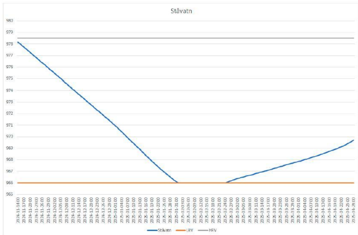
Figur 4 Prognosert vannstandsutvikling Ståvatn i perioden 14.11.2024 -28.04.2025. LRV: 966,00 HRV 978,50
