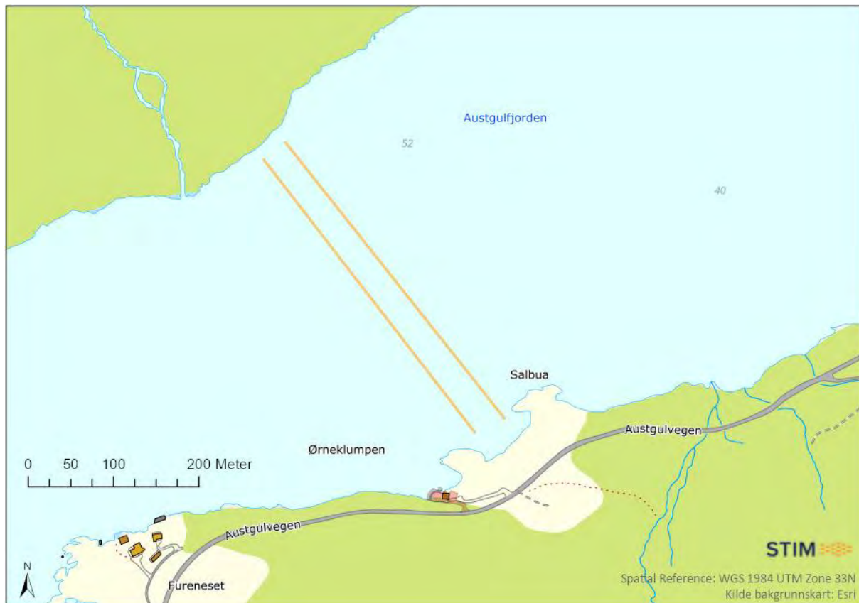
Figur 3.1: Plassering av transekt (videolinjer) som går på tvers over Austgulfjorden langs den planlagte sjøkabeltraséen.
