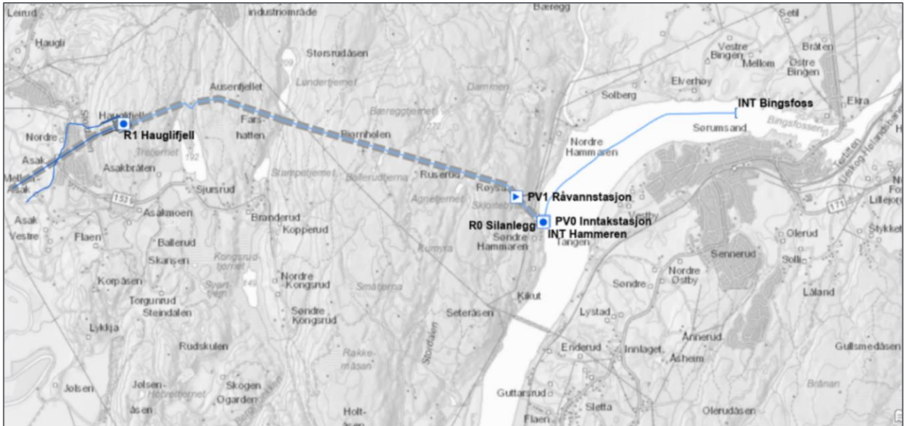
Figur 1-5: Dagens anlegg med rørledninger fra Glomma gjennom pumpestasjon på Hammeren og videre til renseanlegg. Fra Asplan Viak
