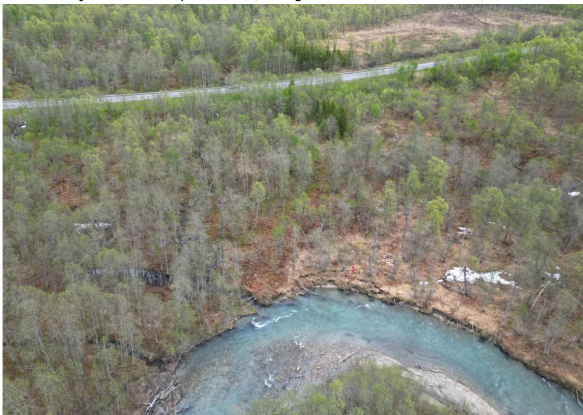
Foto 9: Erosjon i elven ved planlagt motfylling ca. profil 2000, se tegn V06-04 (Foto: H.Lissman)
