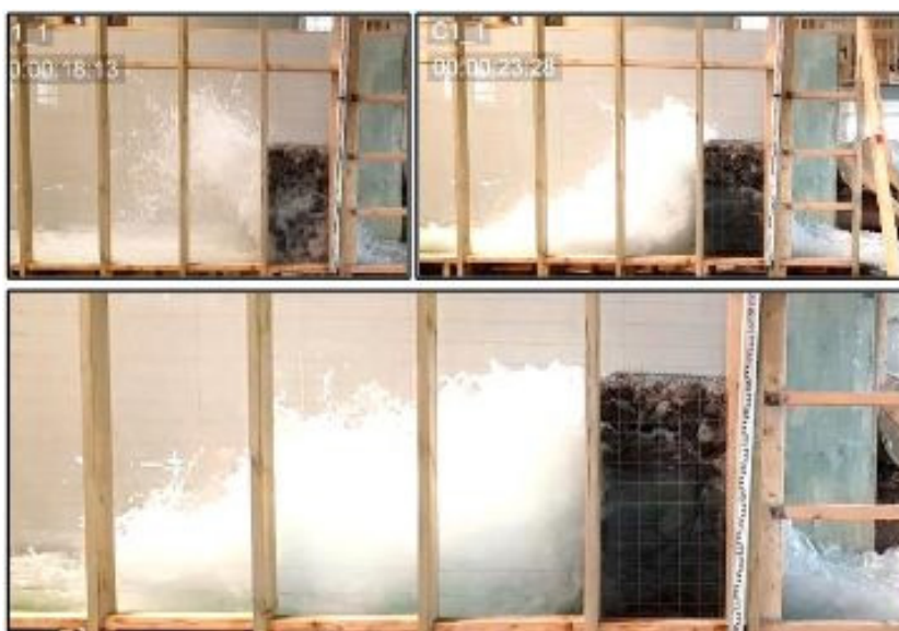
Figur 9-2 Permeabel gabionmur. Øyeblikksbilde: 0,6 s, 1,25 s og 2 s etter første påvirkning (fra Hákonardóttir et al., 2024).
