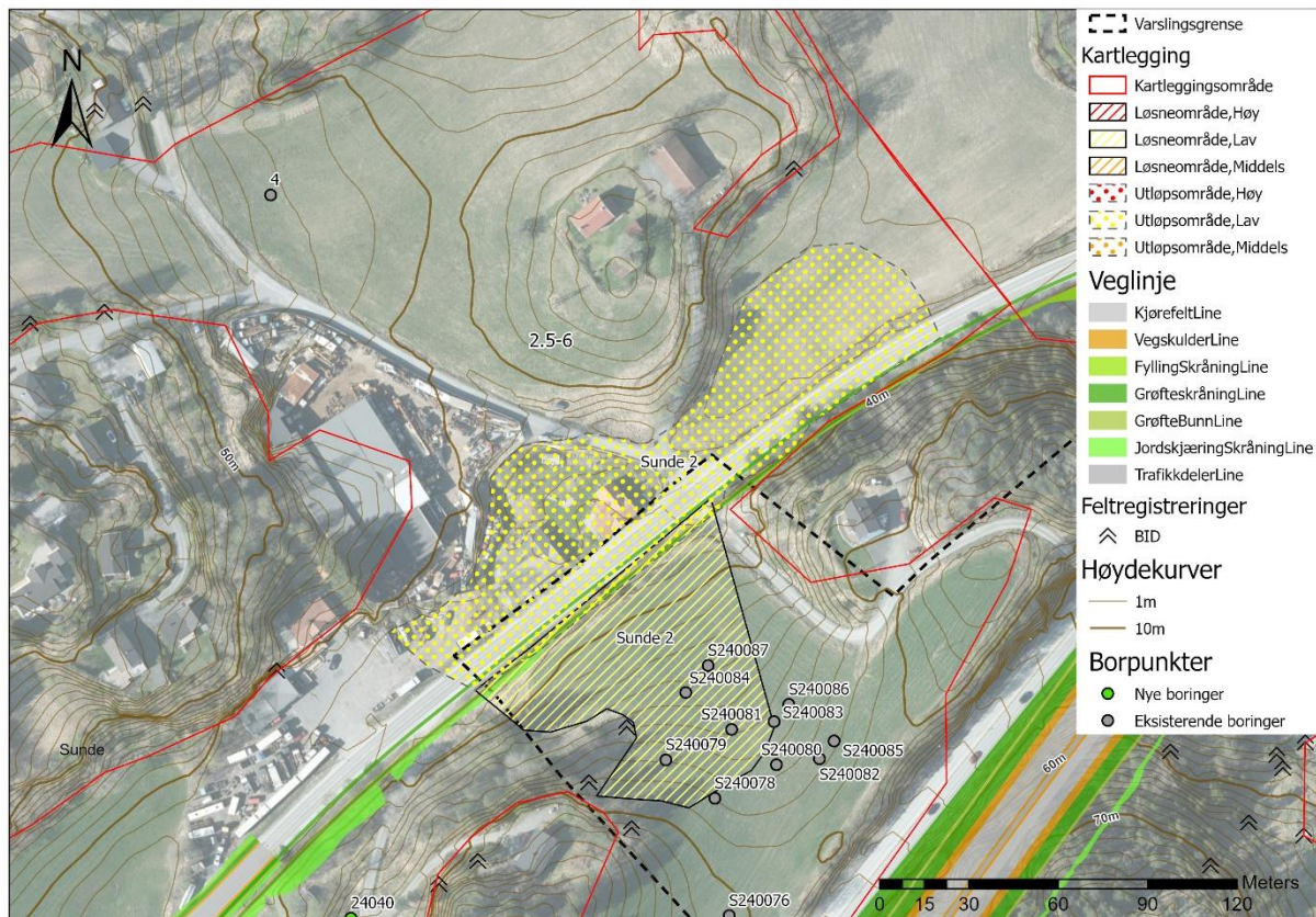
Figur 7-7: Opptegning av løsne- og utløpsområde for Sunde 2 faresone.
