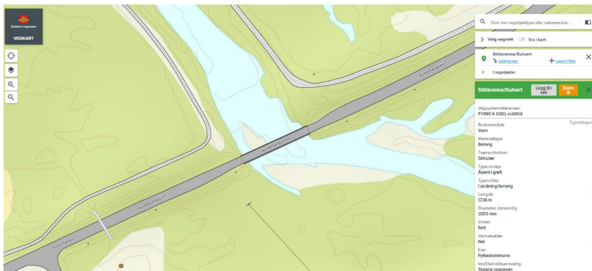
Figur 5-3. Fv. 890 og Basavce bru og stikkrenne vest for bru (hvit linje tvers over vei, vest for elva, BET 1000 mm).
