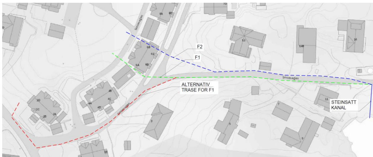
Figur 3-1: Alternative traseer for flomavledningssystem.
