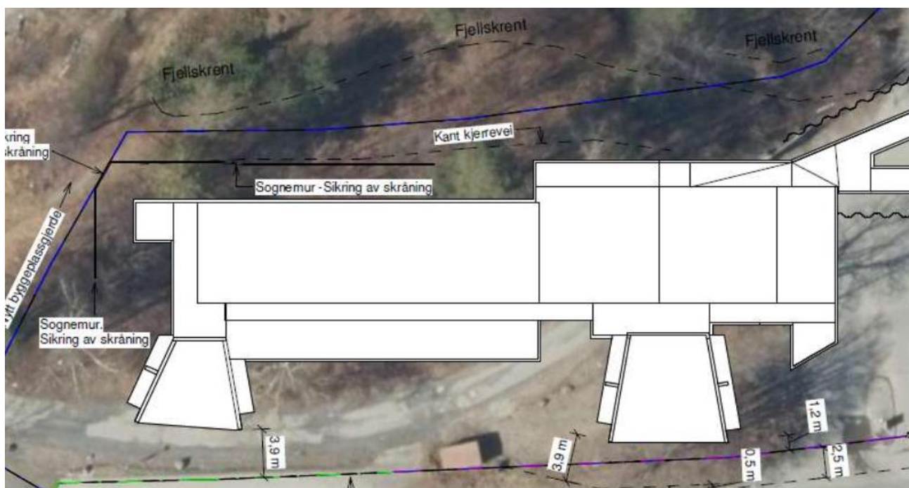
Figur 4-2. Sikring av skråning (sognemur) ift forsjøvet ny inngrepssone mot nord (blå linje)
