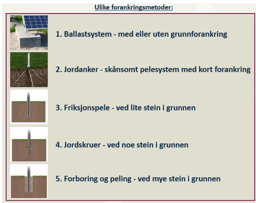
Figur 9. Ulike forankringsmetoder for montasjesystemet til bakken
