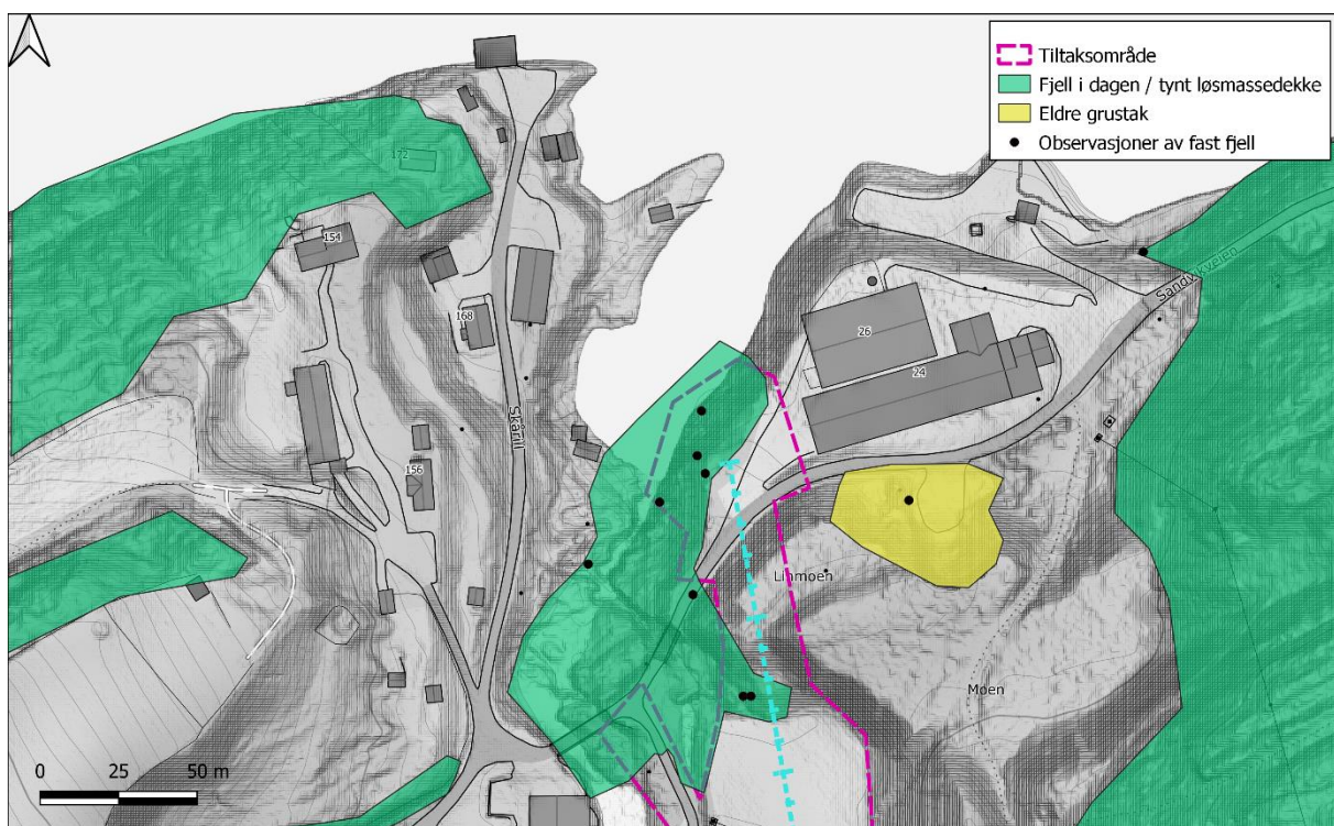
Figur 16. Kart som viser sammenstilling av observasjoner og tolkning av terrengoverflate ved planlagt kraftstasjon. Det er tynt løsmassedekke, og ikke sammenhengende lag med marin leire i området.
