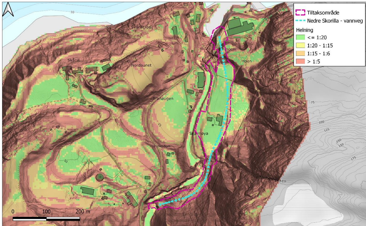
Figur 10. Kart som viser helningen i området, fremstilt ved rasteranalyse av digital terrengmodell fra hoydedata.no.
