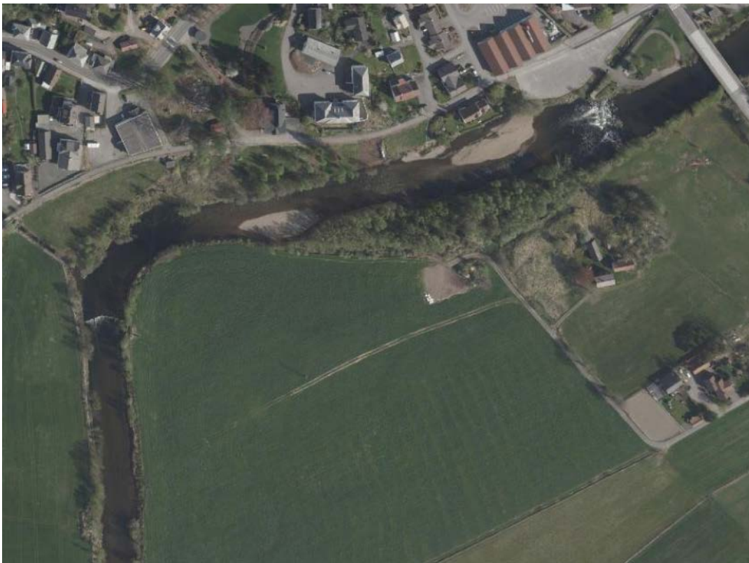
Flyfoto fra parti av Sokno ved hauge i Dalane i 1969 (øverst) og 2014 (nederst). Bildet viser hvordan elveløpet har blitt snevret inn og sideløp avstengt. Bildet viser også de to tersklene i Sokno.
