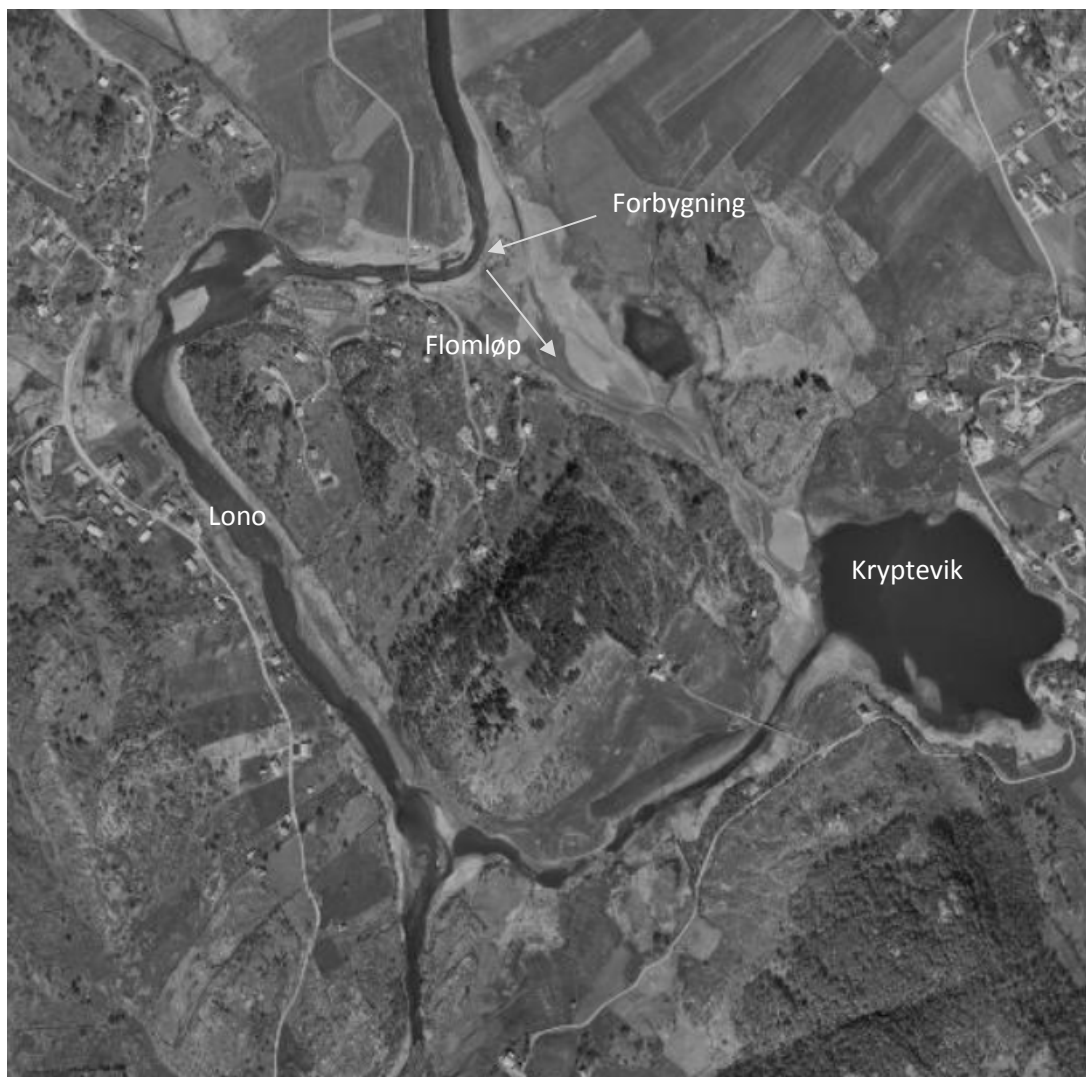
Flyfoto fra nedre del av Sokno fra 1969 (øverst) som viser et flomløp som har ledet vann inn i Kryptevik og inn i Sokno igjen ved utløpet av Lono. Det er mulig at dette også har vært et gammelt elveløp. Bildet viser også at det er laget en forbygning i svingen for å hindre at elven tar denne veien igjen.
