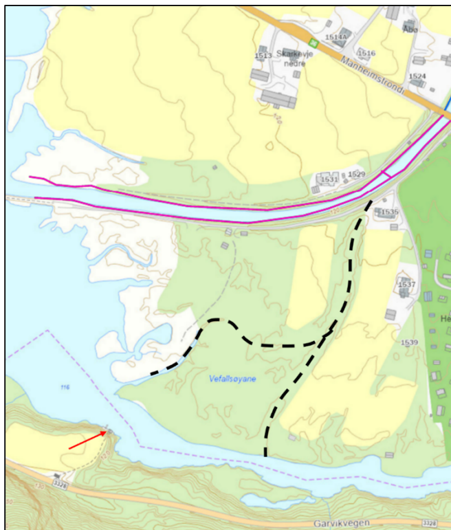
Figur 14: Kart fra NVE Atlas. Rød pil angir plassering av luka. Svarte stiplede linjer viser to av flere mulige tidligere løp for Bjønndøla. Rødlilla og blå streker viser sikringstiltak langs Bjønndøla etablert i 1954, 1958 og 1980, og med formålene korreksjon av elveleiet, opprensning og erosjonssikring.
