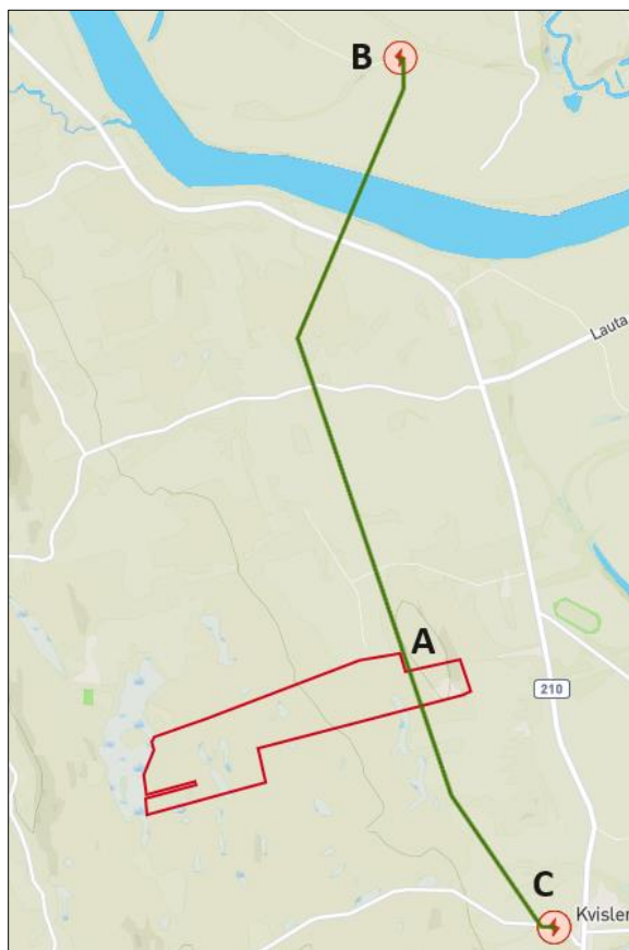
Figur 1-8: Lokasjon av de tre aktuelle nettilknytningspunktene. Den grønne linja indikerer traséen til den eksisterende kraftledningen mellom Kvisler og Åsnes transformatorstasjoner. Omrisset av planområdet er vist i rødt.
