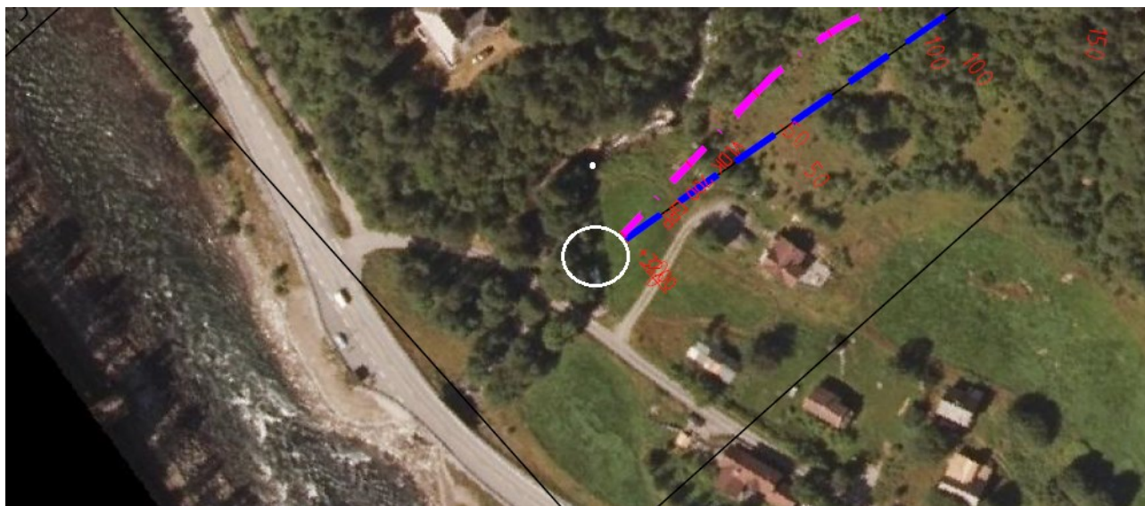
Figur 37 Omsøkt revidert kraftstasjonslokalisering, flytta frå kôte 25 til 30.
