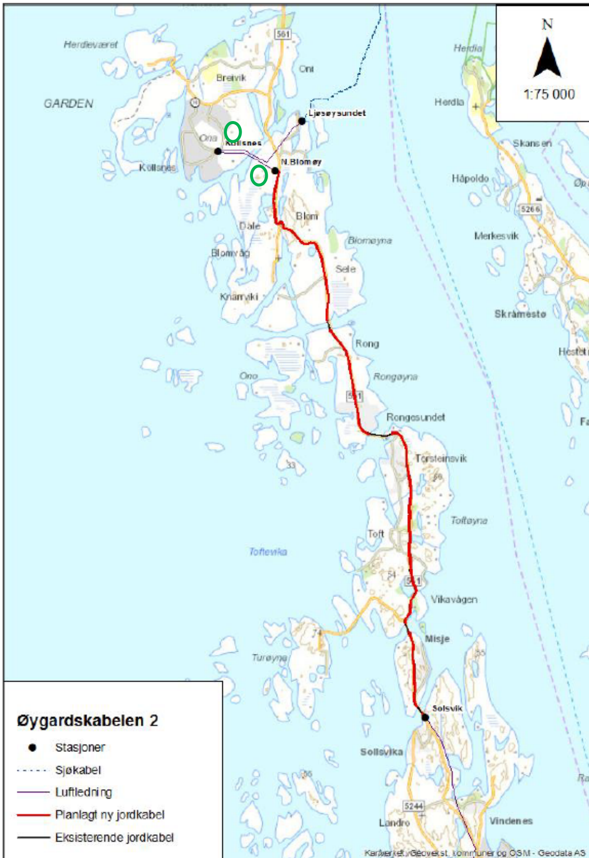
Figur 2-5. Utsnitt fra Statnett sin konsesjonssøknad om «Øygarden 2» - oppgradering av jordkabel mellom Solsvik og Nordre Blomøy. Tiltaket er gitt konsesjon i 2022 og er med i nullalternativet. De to stasjonsalternativene er angitt med grønn sirkel.
