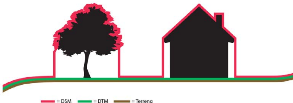
Figur 3-1. Illustrasjonen viser forskjellen mellom overflatemodell (DOM (her DSM)) og terrengmodell (DTM), og hvordan DOM-scanningen oppfatter de ulike elementene (Kilde: NIKU 2016).
