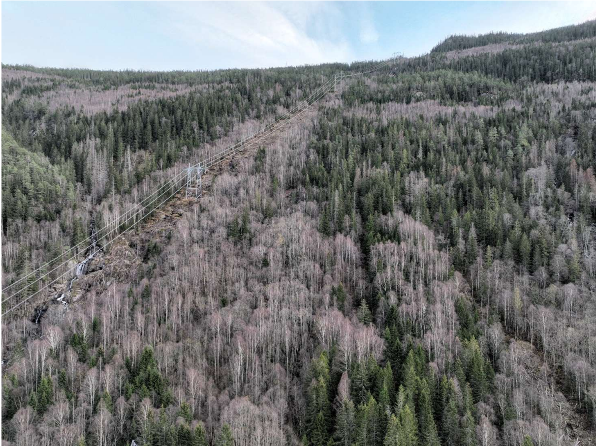
Figur 3-8: Dronebilde som viser eksisterende skogskorridor til venstre for planlagt korridor. Terrenget under høyspentmastene har stor ruhet og det er skrint med løsmasser
