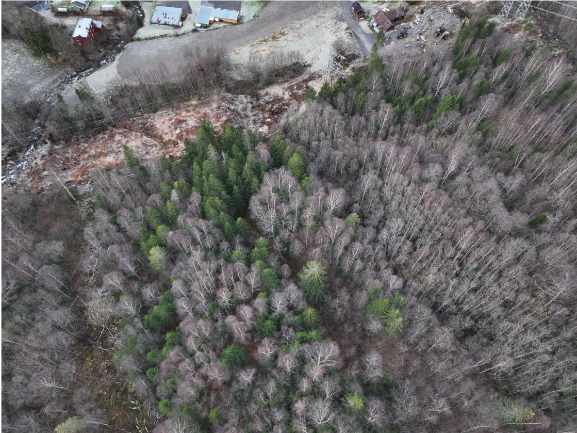
Figur 3-7: Dronebilde som viser ravineterrenget i nedre del av fjellsiden. Det er ingen tegn til skredaktivitet eller skader i skogen. Mellom fjellside og bebyggelse er det et flatt myrområde.
