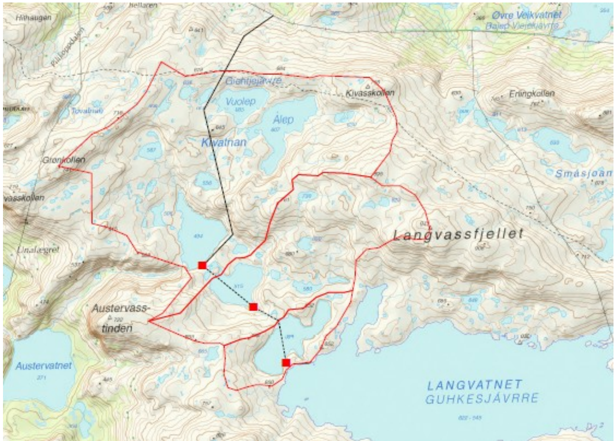
Figur 1 - Kart over omsøkte løsning med tre pumpestasjoner og 22 kV-ledning som skal forsyne pumpene med strøm. Pumpestasjoner er vist med rød firkant. Luftledning er vist med svart heltrukket linje og kabler i sjakt er vist med stiplet linje.
