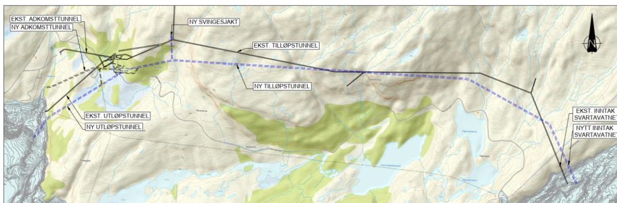
Figur 2-11 Plantegning av planlagt vannveg Sotabotnen kraftverk. Utsnitt fra oversiktstegning (vedlegg 1)
