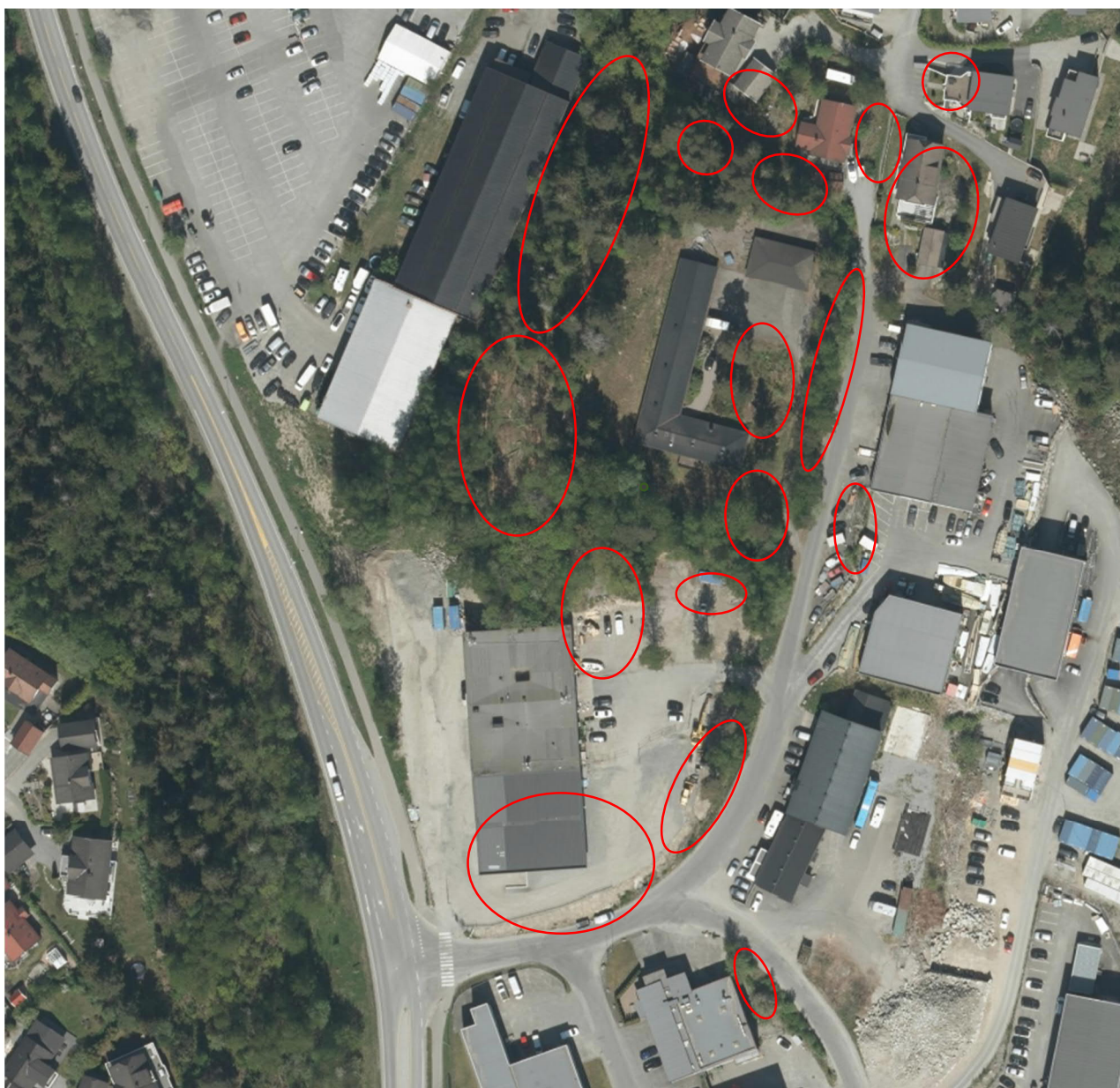
Områder med observasjoner av berg i dagen fra befaring, flyfoto og gatebilder
