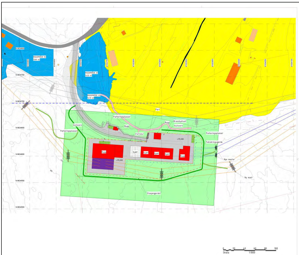
Figur 2-1: Foreløpig situasjonsplan for Liåsen transformatorstasjon, alternativ A.
