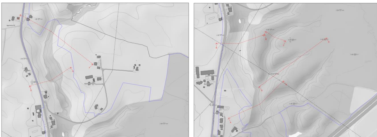
Figur 7 Beregningsprofiler med tilhørende sonderinger. Nordorientert.
