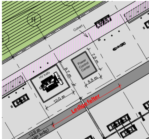
Figur 10: Situasjonsplan høyspent transformator og kontrollcenter
