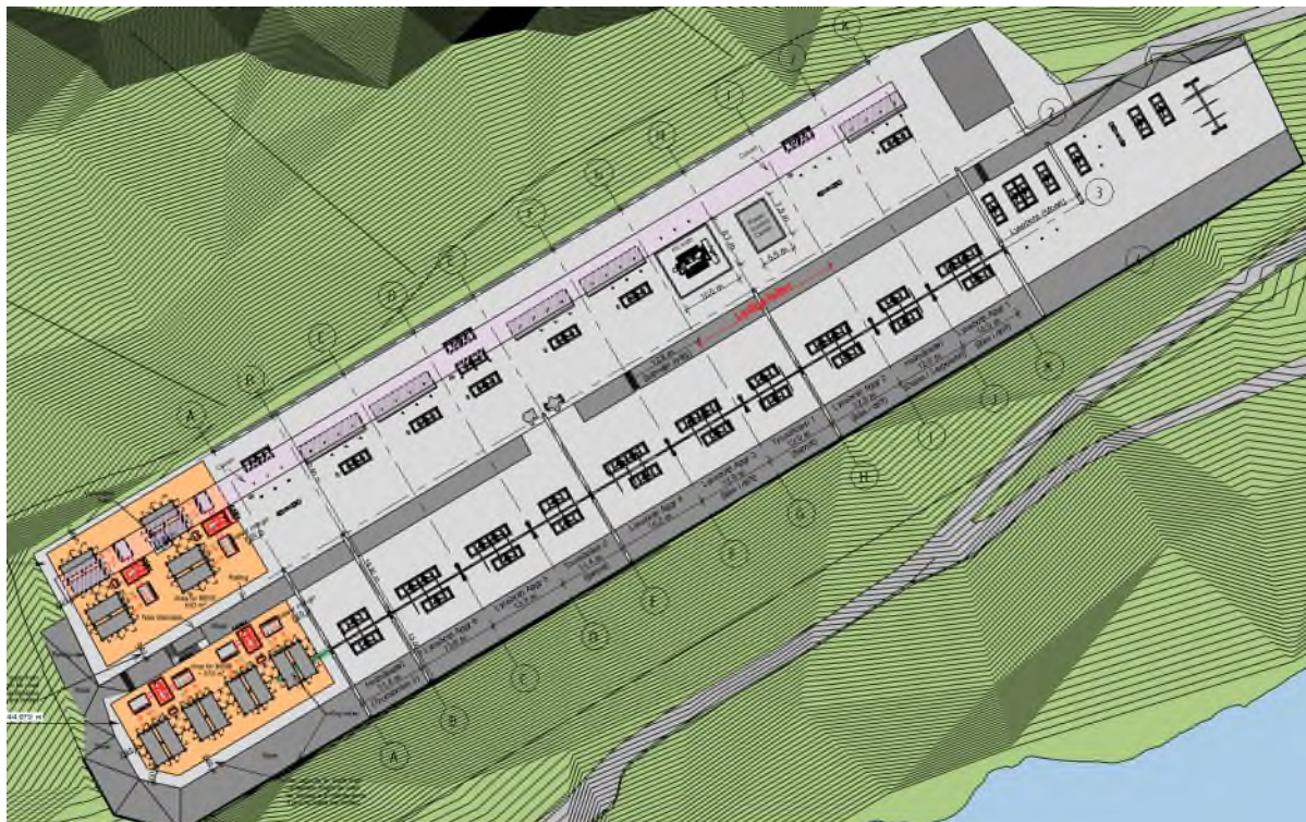
Figur 8: Situasjonsplan Måkalia koblingsanlegg
