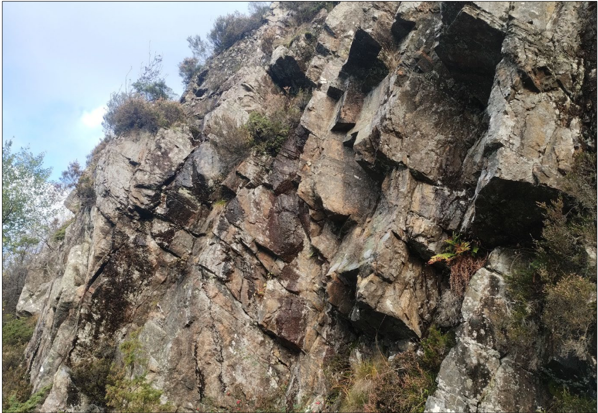
Figur 9: I nordaustleg del av påverknadsområdet er det eit fjellparti med vesentleg oppsprekking og tydelege brotplan langs foliasjonsplana. Nedanfor dette fjellpartiet ligg og eitt av få område med samanhengande steinsprangmateriale (Figur 28). Infopunkt 1.
