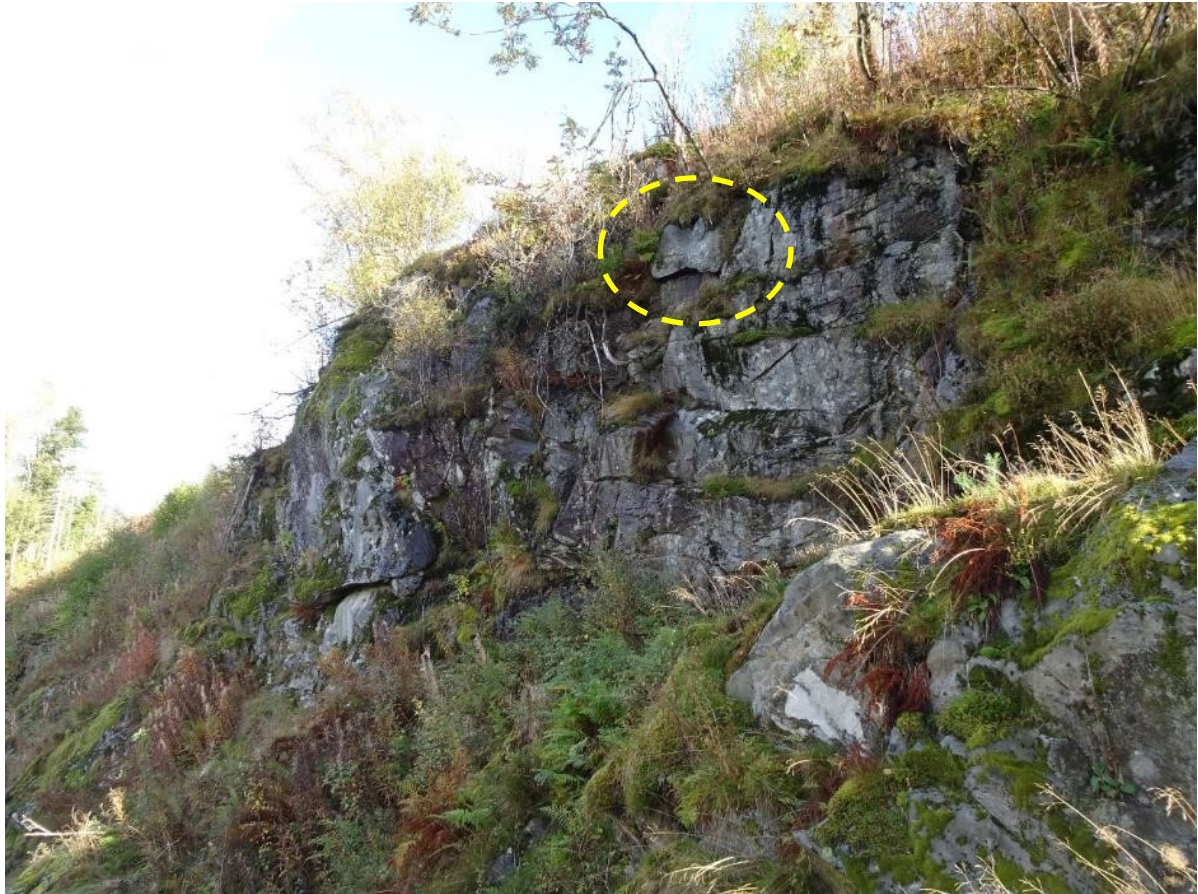
Figur 8. Bergskrent lokalisert 30 meter sør for naustområdet. Gulstiplet ellipse markerer eksempel på avløst blokk.
