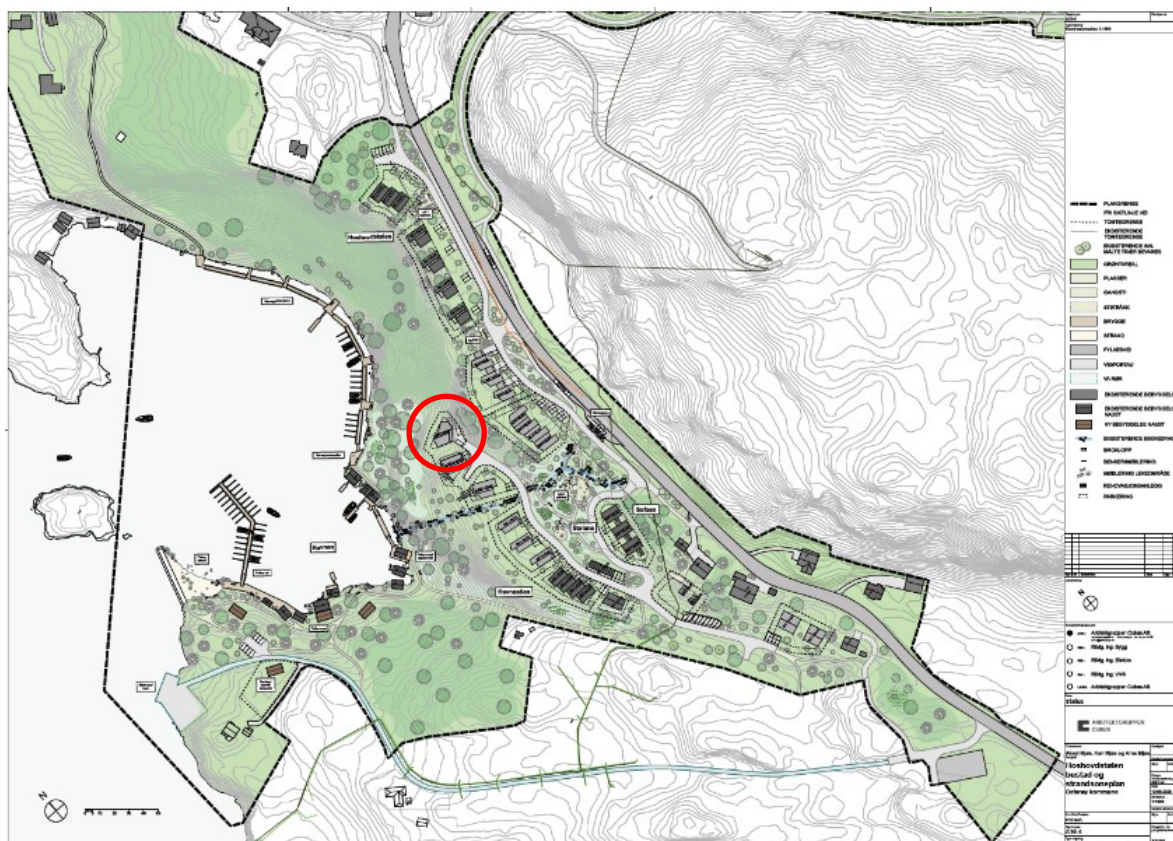
Figur 25. Utklipp fra illustrasjonsplan. Rød sirkel indikerer et område der det kan bli aktuelt å utføre sikringstiltak mot skred i forbindelse med oppføring av bolig.
