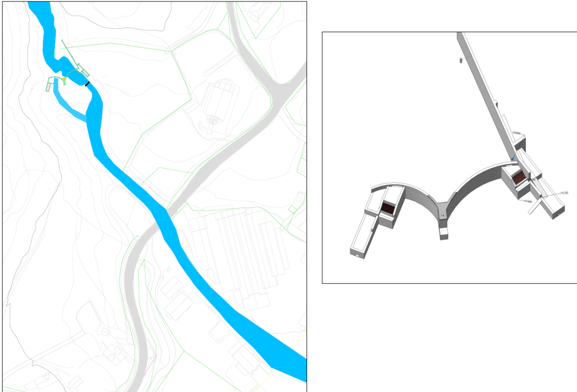
Figur 1. Venstre: Anadrom del av Onarheimselva med inntaksdam inntegnet i grønt, eksisterende inntaksdam er markert med svart strek. Høyre: 3D modell av den nye inntaksdammen. Kilde: Bystøl AS.
