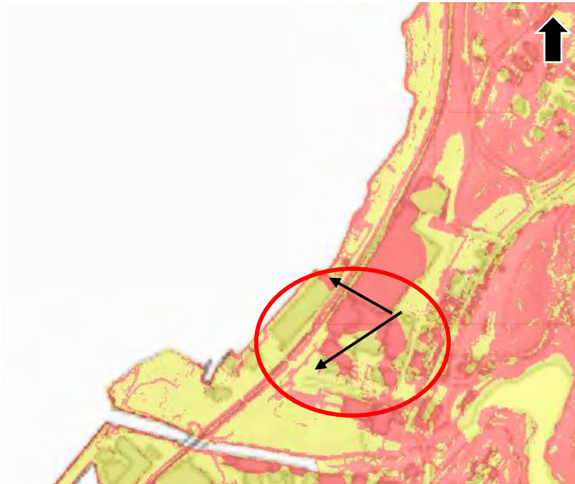
Figur 5: Utklipp fra tegning 101 rev. 02 i rapport 20190539-11-R Rev.Nr. 5 [9]. Områder markert i rødt har en helning > 1:15. Omtrentlig helningsretning for aktuelle skråninger er angitt med sorte piler.
