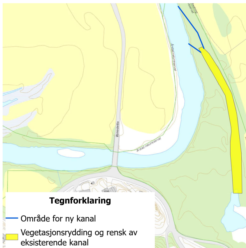
Figur 18 Ny åpning fra Sokno og rensk i eksisterende kanal for å øke vannføringa inn til /Kryptevig.
