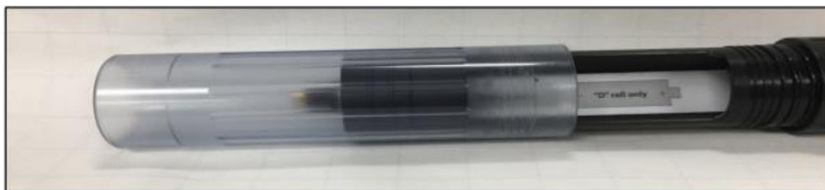
Figur 7. Apparaten som har vorte nytta til og måla Gassmetning i Fortunselvi. Monteringsoppsett for ein av dei fire gassmetningsmålarane i Fortunselvi er vist på framsidebiletet i denne rapporten.
