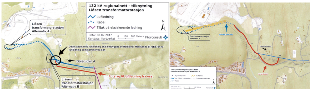
Figur 30: Forslag til alternativ luftledningstrasé på sørsiden av dagens 420 kV ledning (til venstre). Forslag til jordkabeltrasé som alternativ til luftledning forbi Dølerudveien 4.
