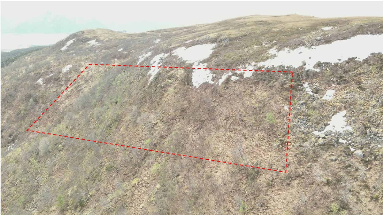
Figur 9: Løsneområder snøskred indikert med rødt. Terrenget slaker av i nedkant, med helning under 30 grader.
