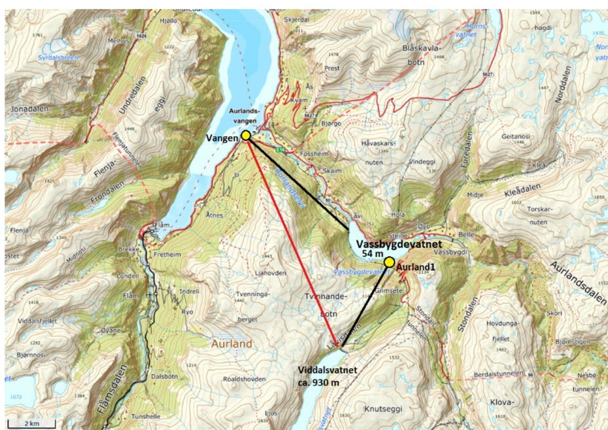
Figur 1: Kart over området. De svarte linjene indikerer eksisterende tunneler (ikke korrekte posisjoner), fra Viddalsvatnet til Aurland 1 og fra Vassbygdevatnet og Vangen. Disse to kraftverkene er markert med gule prikker. Planlagt nytt kraftverk (Låvi) er ikke tegnet inn på kartet, men det vil gå vann direkte fra Viddalsvatnet og til fjorden (rød linje).
