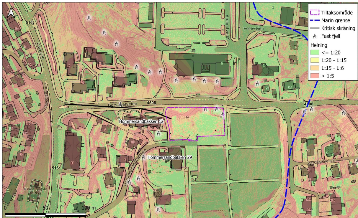
Figur 11: Det er identifisert en kritisk skråning ved tiltaksområdet ut ifra helningskart. Observasjon av berg i dagen tyder på tynt løsmassedekke i og rundt området.
