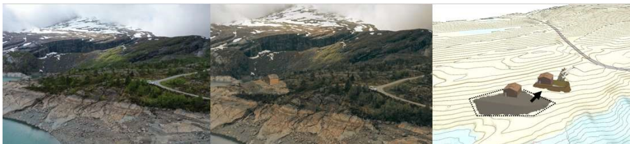
Figur 7. Visualisering av lukehus ved Store Øksendalsvatn. Noverande tilstand til venstre og forslag til ettertilstand i midten. NB! I forhold til visualiseringa vil lukehuset bli trekt nærare vegen og lagt lågare i terrenget. Fyllinga vil òg bli redusert monaleg, spesielt i nedkant. Skisse til høgre viser ny løysing for plassering av lukehus med mindre fylling og plassering nærare vegen.
