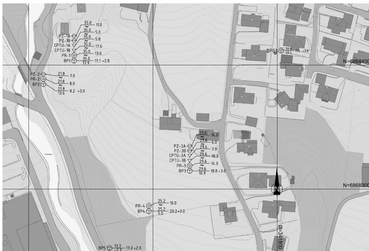
Figur 4-5: Utsnitt fra borplan for supplerende grunnundersøkelser for Høgebakkane, tegning nr. 10228011-RIG-TEG-001.
