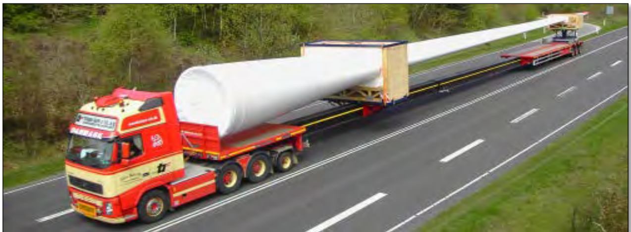
Govus 6-7. Rohtorsoajáid fievrrideamis leat stuorra gáibádusat sihke fievrruide ja infrastruktuurii (geainnuid vealu- ja ceakkorádusii). Govven: Nordex.
