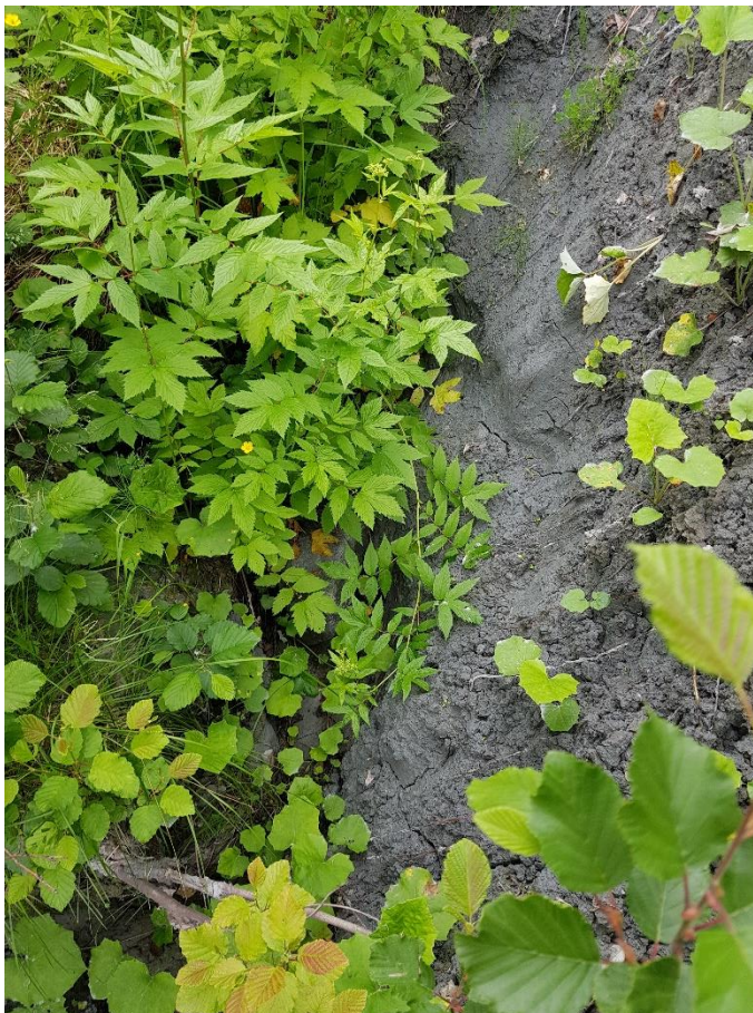
Figur 6: Bløt leire i seideravinen. Erosjon i leire.
