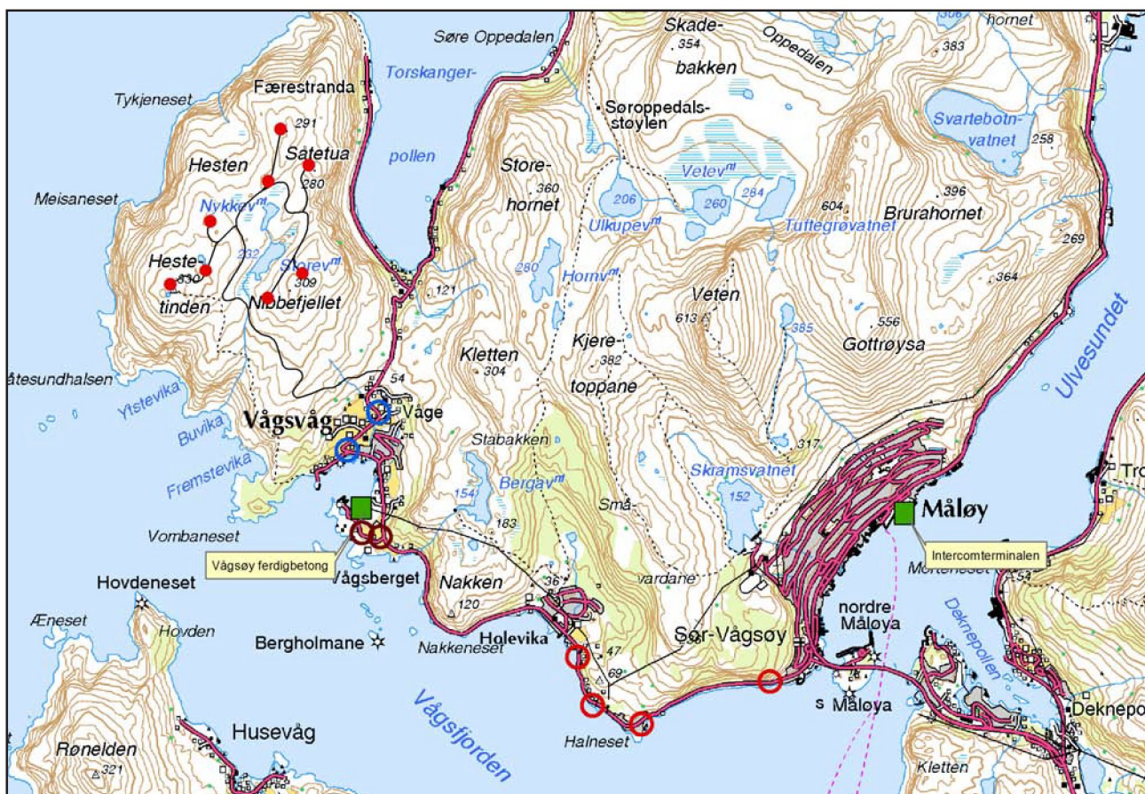
Figur 7-3. Veistrekninger der det kreves utvidelsestiltak for transport av turbinkomponenter. Blå sirkler viser tiltakspunkter som gjelder begge ilandføringsalternativene, røde sirkler gjelder bare ved ilandføring i Måløy.
