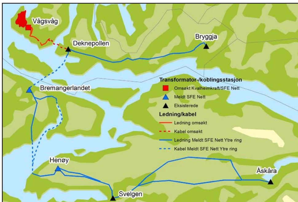
Figur 7-7. Tilknytning av Vågsvåg vindpark til planlagt regionalnett. Rød strek viser løsning som omsøkes i denne søknaden. Den meldte Ytre Ring Nordfjord er vist med blått. Melding om netttiltaket kan lastes ned fra www.nve.no eller www.sfe.no
