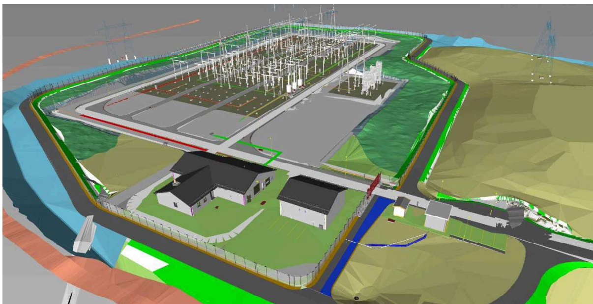
Figur 6 Utklipp fra 3D-modell over Langerud koblingsstasjon. Figuren viser blant annet kontrollbygg, lager, nettkiosk og IKT-kiosk, samt koblingsanlegg og deponi (til høyre i figur).
