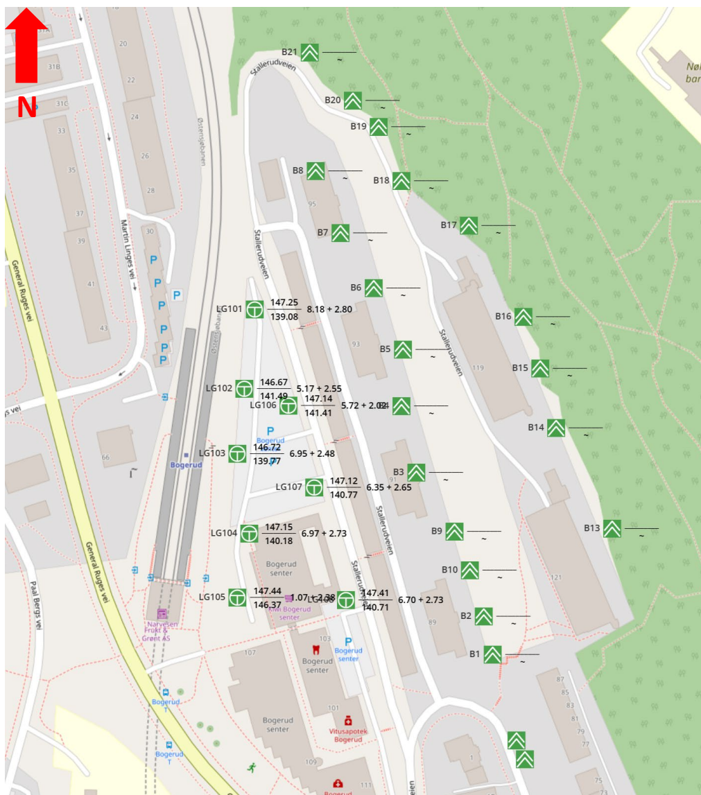
Figur 2-4: Utklipp fra borplan for supplerende grunnundersøkelser [6]
