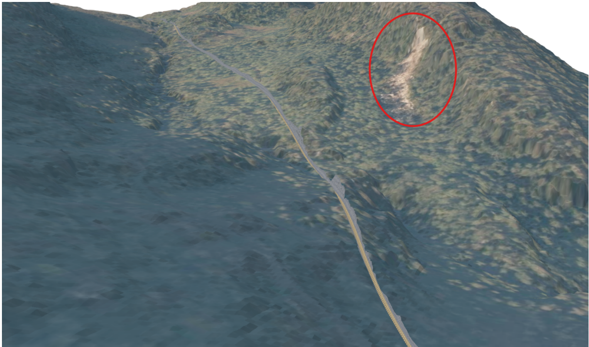
Figur 34 3D-modell med flyfoto drapert, som viser løsmasseutglidning
