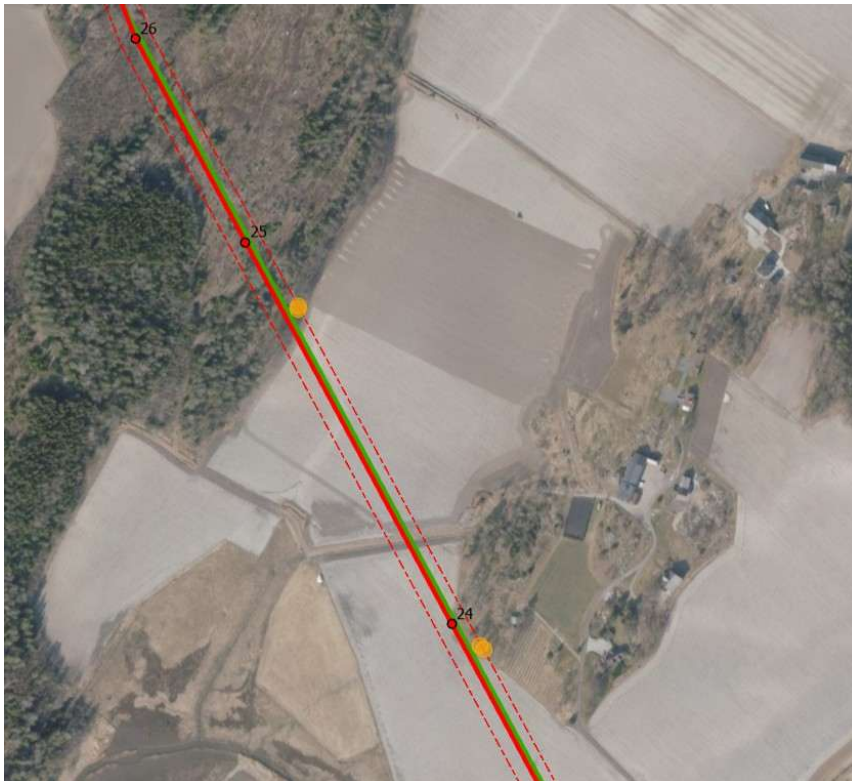
Figur 2-17: Justert trasé forbi de hule eikene. Ny trasé med rødt, eksisterende trasé med grønt og hule eiker med gult.
