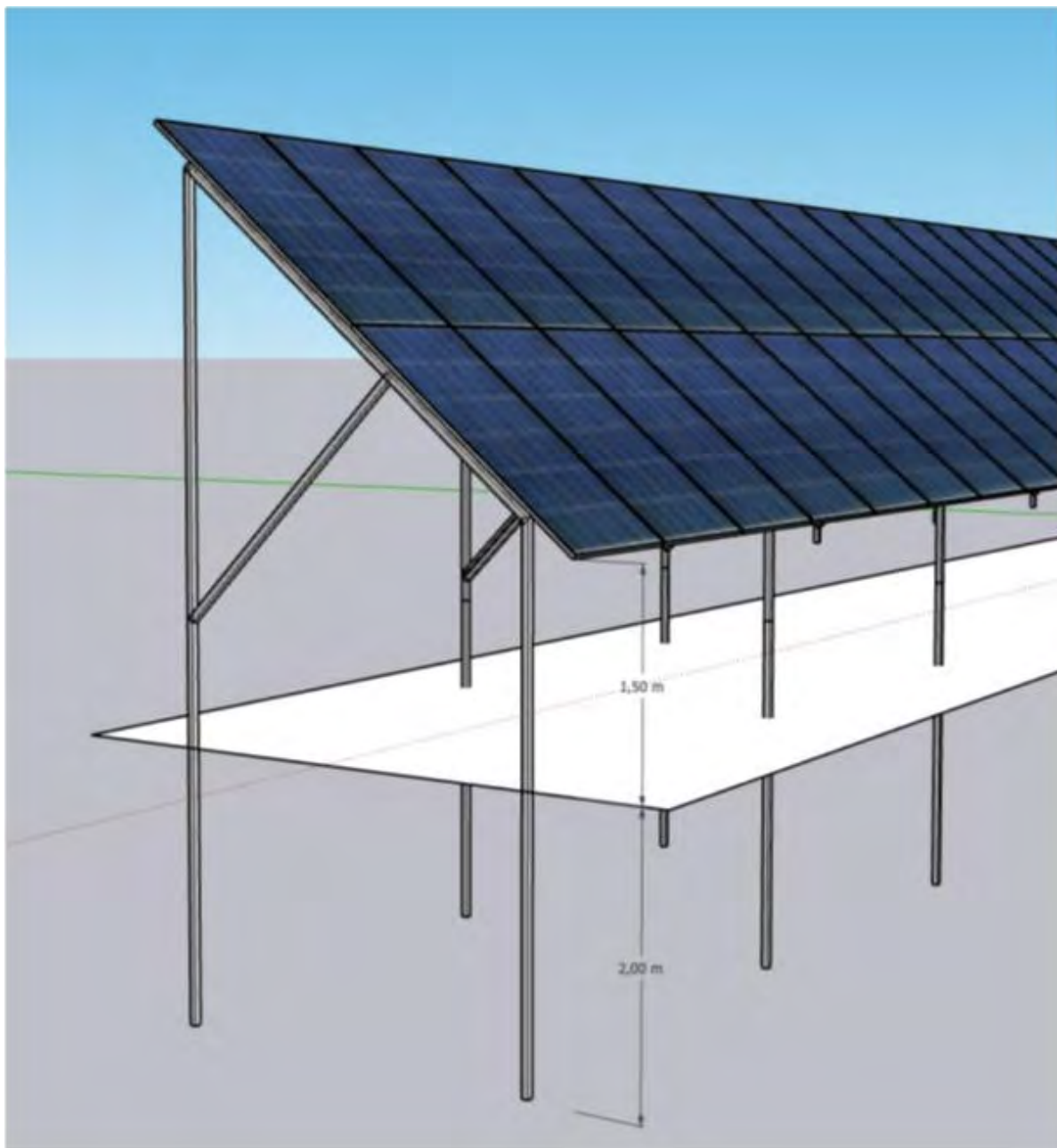
Figur 2-1 Eksempel på montasje av paneler i 2P.
