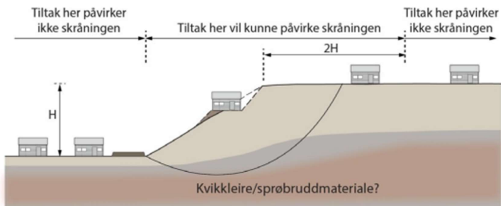
Figur 3.4 Terrangsnitt som viser prinsipp for når en skråning kan vurderes upåvirket av tiltaket (utenfor tiltakets influensområde).
