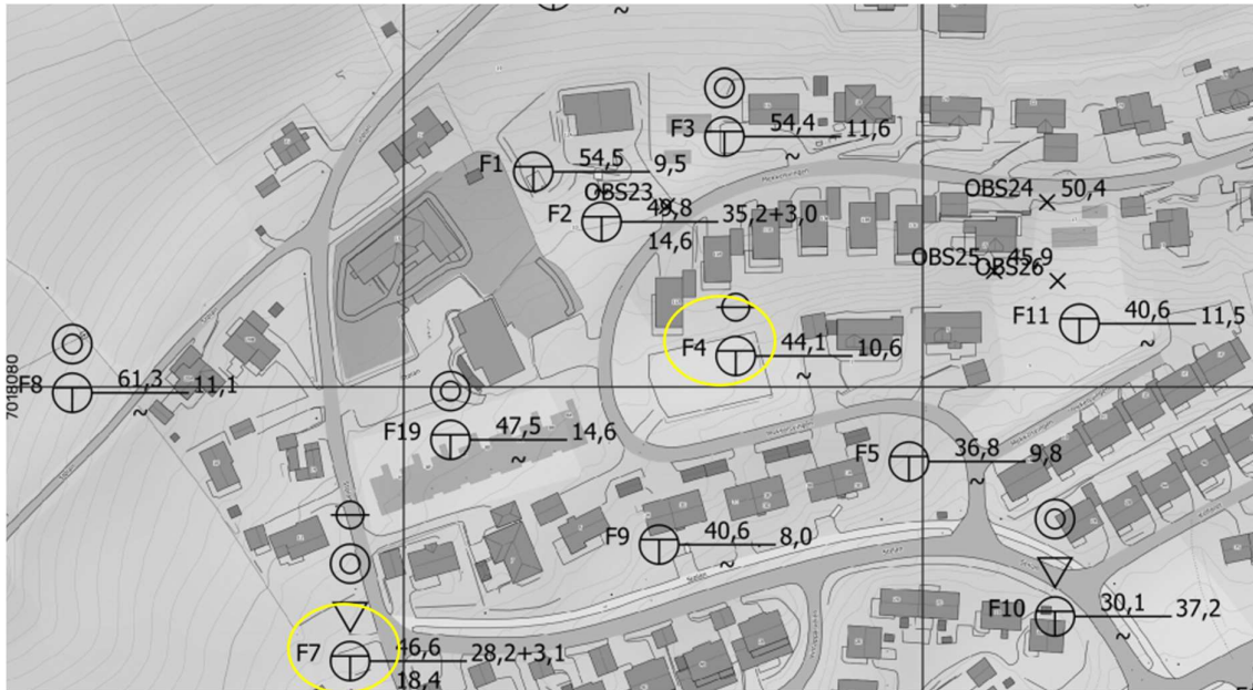
Figur 6: Plassering av piezometere.
