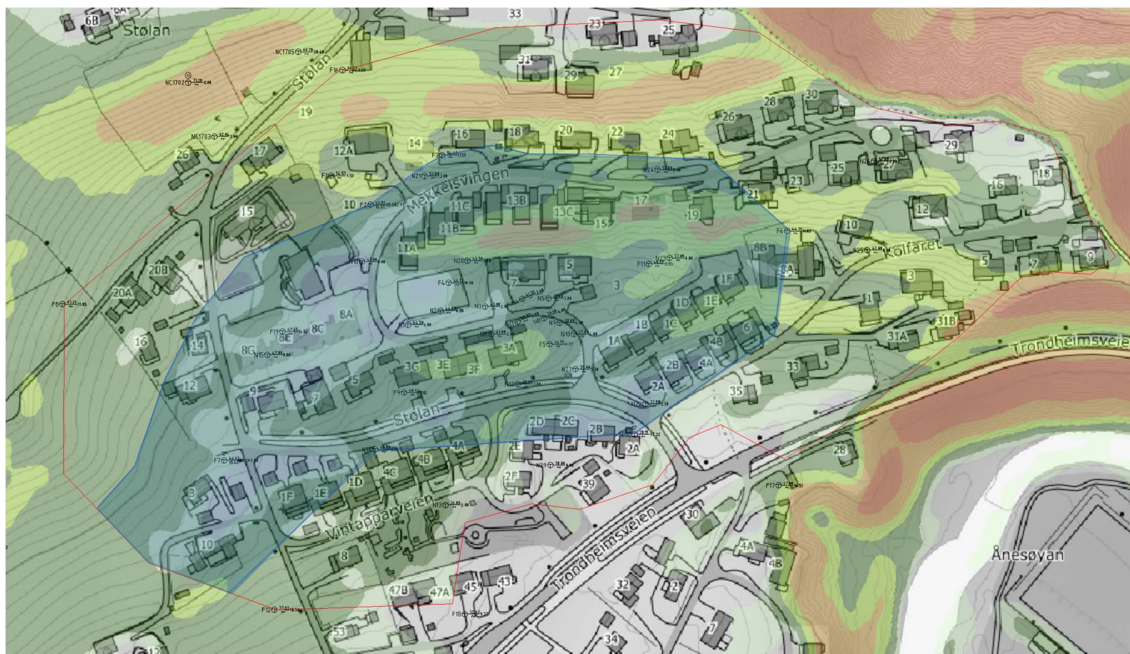
Figur 20: Blått område markerer område med mulig utbredelse av retrogressivt skred. Resterende områder er rotasjonsskred/flakskred som aktuell skredmekanisme.
