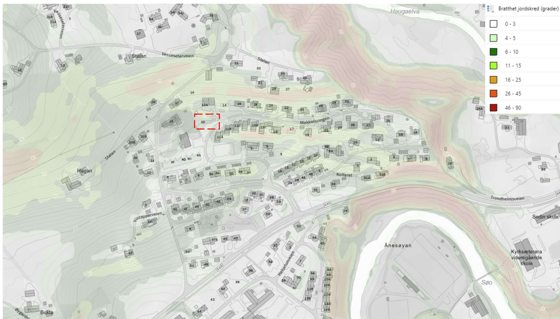
Figur 3: Kart med helning der terren med farge er brattere enn 1:15. Plassering av tomt med utførte gravearbeider markert i rødt (Kilde: atlas.nve.no, hentet: 8.4.2024)
