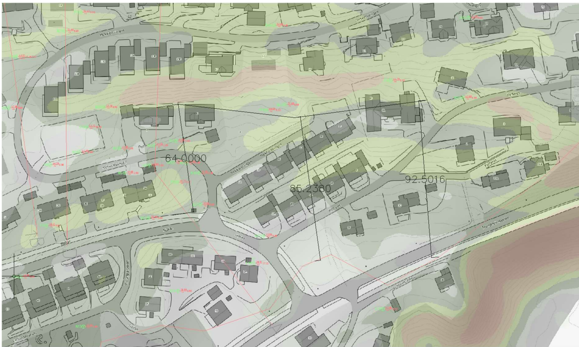
Figur 35: Utløp for skred med sikkerhet under 1,2. Antatt at utløpsdistanse ikke vil overskride kritisk beregning i snitt A. Beregnet utløp i snitt A er 64 m. Dette er meget konservativt med retrogressivt som skredmekanisme.
