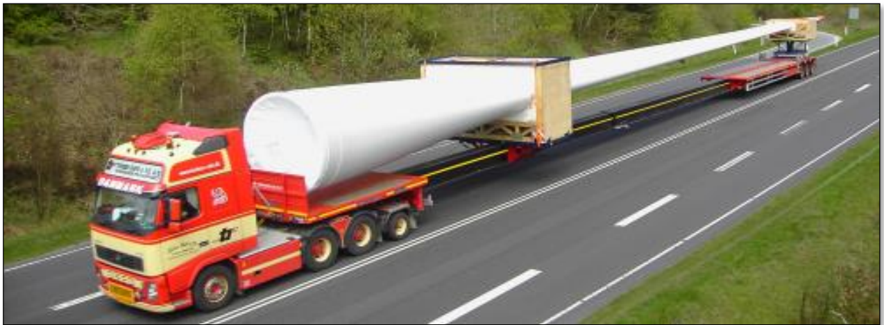
Figur 6-7. Frakt av rotorblader stiller store krav både til kjøretøy og infrastruktur (horisontal- og vertikalradius på veier). Foto: Nordex.
