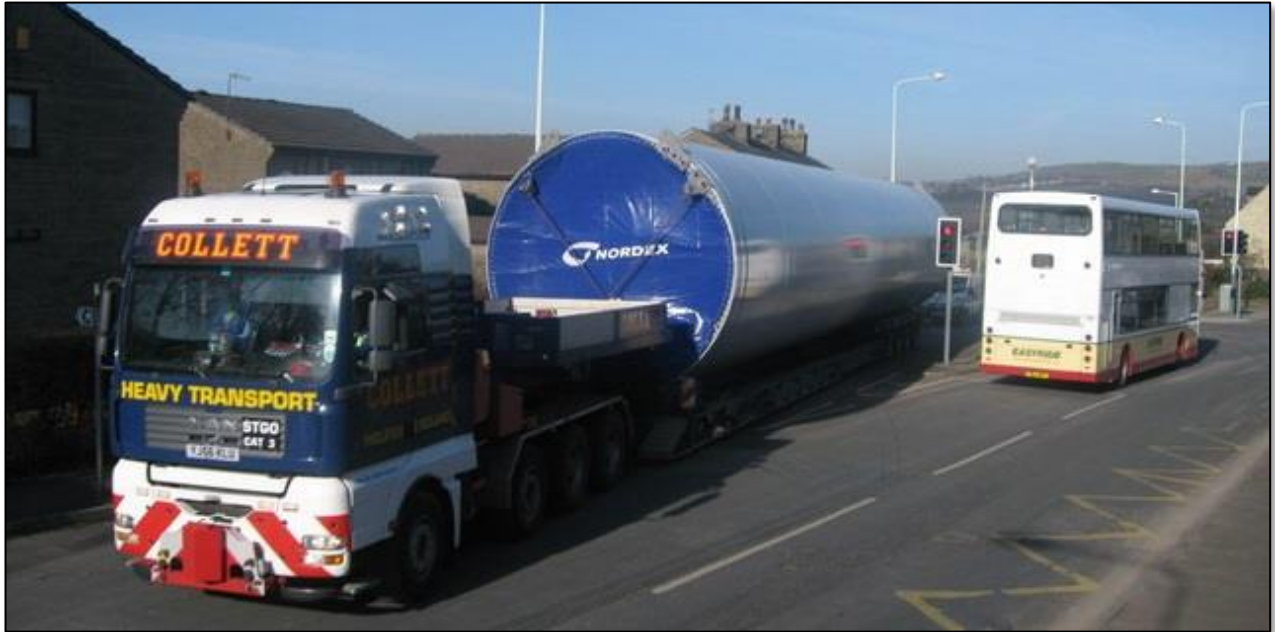
Figur 6-6. Frakt av tårn med spesialkjøretøy. Foto: Nordex.
