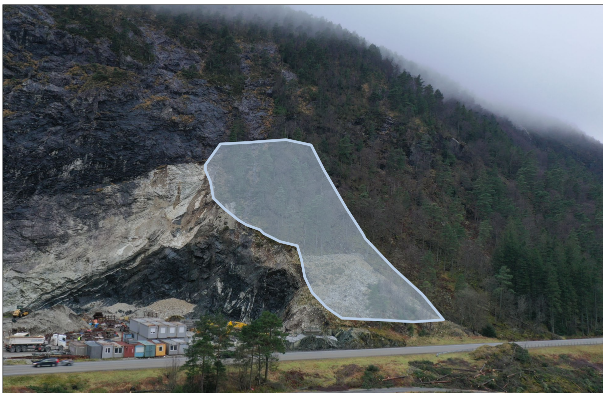
Figur 23: Dronebilde som viser kva område det må fjernast lausmassar og fjell for å unngå utrasing på ny avkøyrsløse.
