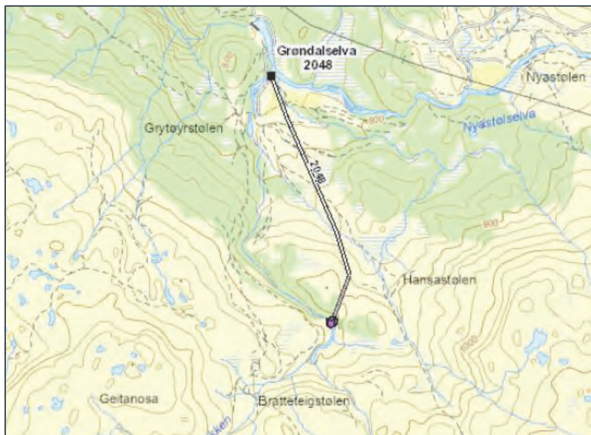
Figur 3: Inntaksområde, vannvei, kraftstasjon og strekning av Grøndalselva som får fraført vann. Kilde: NVE vannkraft.
