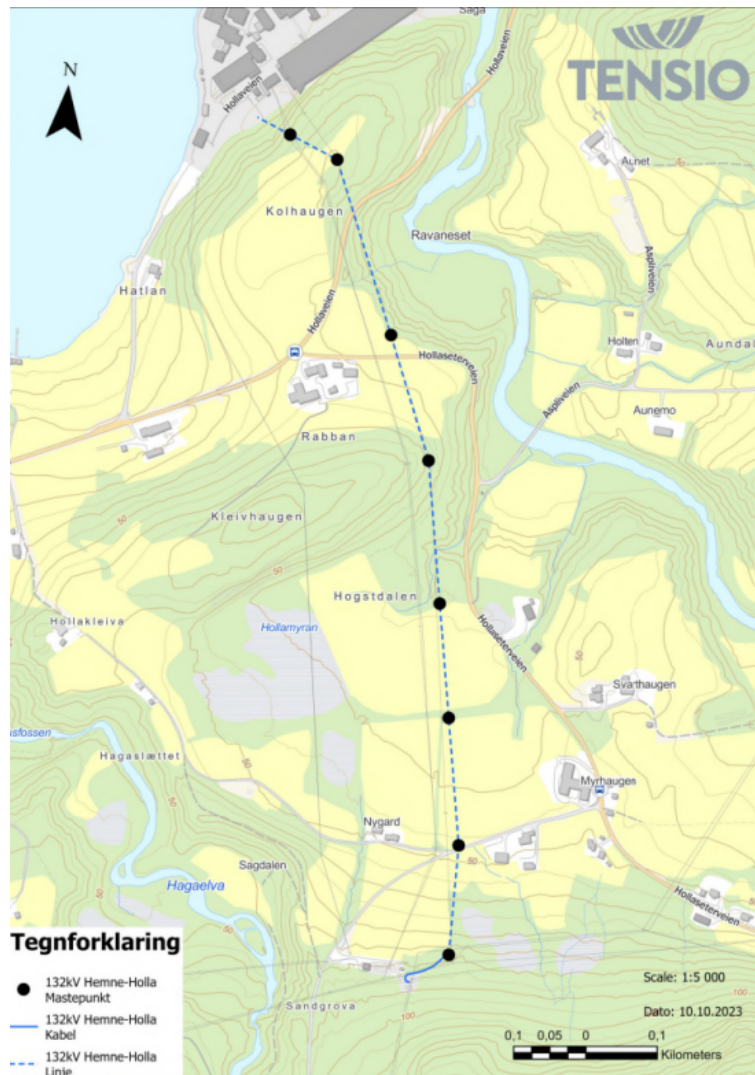
Figur 1: Riving av 22 kV ledning og bygging av ny 132 kV i samme trasé (markert med blå strek)
